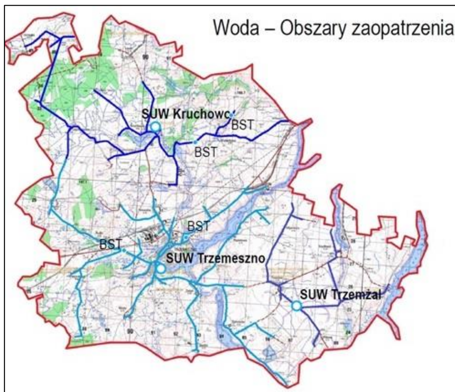
Rysunek 5 Stacje uzdatniania wody oraz obszar zaopatrywania
