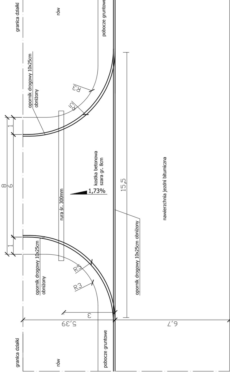
Przepust z rury żelbetowej WIPRO klasy A
